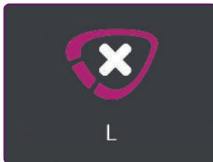
Se la misurazione viene interrotta prima del tempo, l'apparecchio vi avverte, con un messaggio sul display e con un segnale acustico, che il risultato della misurazione non è stato ancora salvato perché la fase di riscaldamento non si era ancora conclusa.
