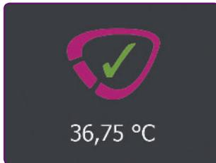
L'apparecchio conferma l'avvenuta misurazione (durata: circa 60-90 secondi) emettendo un segnale acustico e visualizza la temperatura misurata sul display. È assolutamente necessario attendere il segnale acustico al fine di garantire la precisione dei valori rilevati.
